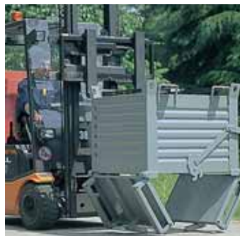
2. Der Boden wird mit Hilfe von Stahlrollen geschlossen.
