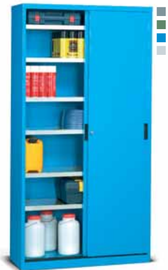
ART. NR. BÖDEN F AB 3300 04 04 6 Schrank mit 6 Fachböden Tiefe 370 mm (100 kg) Tragkraft des Schrankes: 800 kg Abm. mm: 1023x450x2000 H
