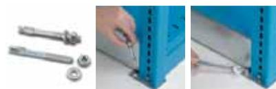
Befestigungsmaterial, bestehend aus 2 Spreizschrauben aus Stahl M8x75 mm für Betonfußböden ohne Risse in oder über der Klasse: B25 / RBK250 / MP<sub>A</sub> 25N per mm<sup>2</sup>.
