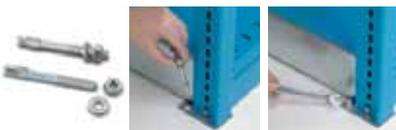
Befestigungsmaterial, bestehend aus 2 Spreizschrauben aus Stahl M8x75 mm für Betonfußböden ohne Risse in oder über der Klasse: B25 / RBK250 / MPa 25N per mm². ART. NR. F NC 8999 00 99
