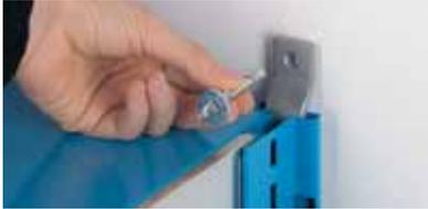
Für die Wandbefestigung muss für jeden Regalrahmen ein Dübel mit einem Zugwert (inklusive Sicherheitsfaktor) von **1,3 Kn** benutzt werden.
