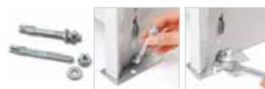
Befestigungsmaterial, bestehend aus 2 Spreizschrauben aus Stahl M8x75 mm für Betonfußböden ohne Risse in oder über der Klasse: B25 / RBK250 / MP<sub>A</sub> 25N per mm<sup>2</sup>.
